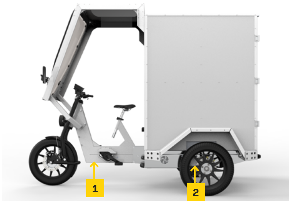
FIGURE 19 : POINT D'APPUI POUR UN CRIC
