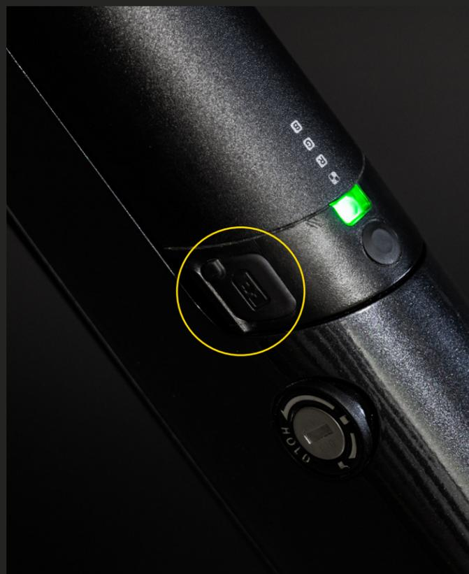
Le système de gestion de la batterie (BMS) peut afficher, à l'aide des LED, l'état de charge. Il peut également afficher le type de protection en cas d'erreur.
